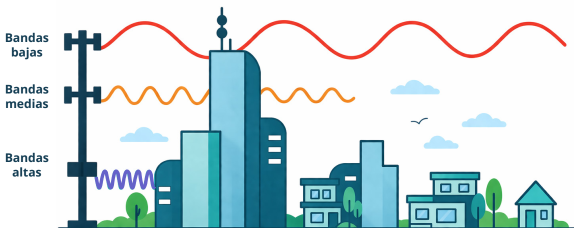
Figura 3. Tipos de bandas de frecuencia para 5G. (Elaboración propia, basada en material disponible en Internet)
